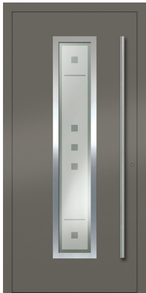
GARDA Farbe: Acrylcolor RAL7039 Glas: ISO-Klarglas mattiert „Sinus“ Zubehör: Edelstahl Ornamentrahmen (flach) Stoßgriff „Ottawa“ Länge: 1620mm
